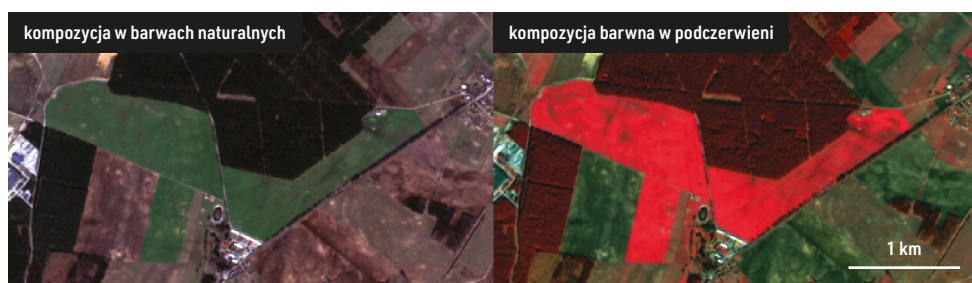
Rysunek 12. Porównanie kompozycji barwnych w barwach naturalnych oraz w podczerwieni.
