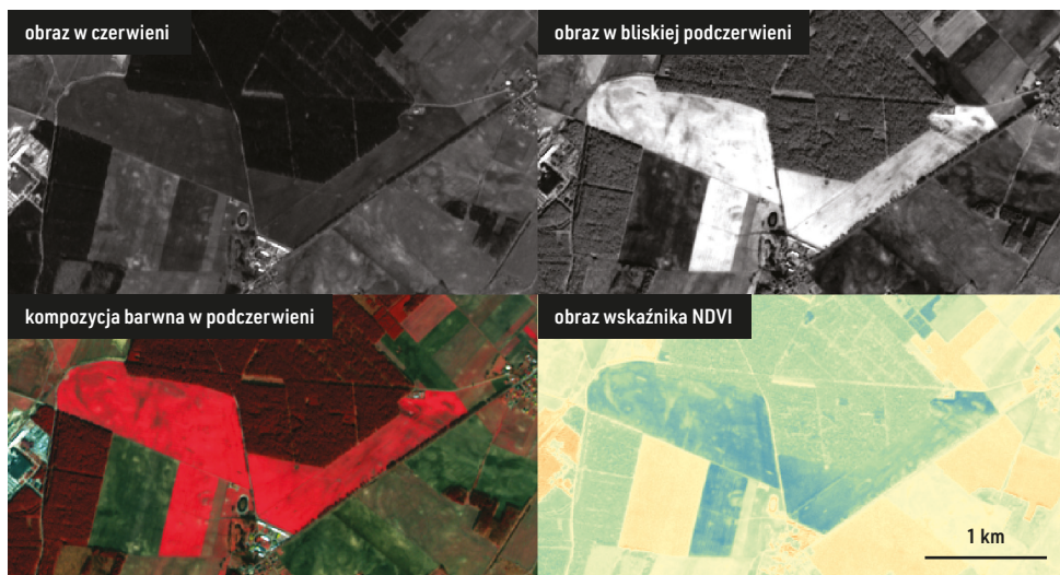
Rysunek 14. Obraz wskaźnika NDVI oraz dwa obrazy spektralne, na podstawie których został on obliczony (czerwony i bliskiej podczerwieni). Można go porównać z kompozycją barwną w podczerwieni.
